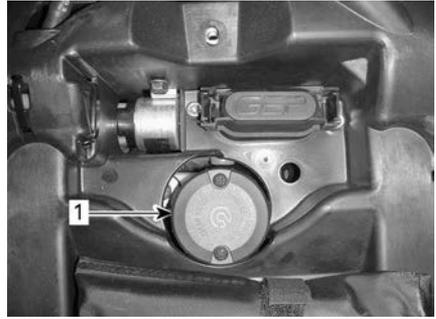
1. Behälter für Bremsflüssigkeit der hinteren Bremse
