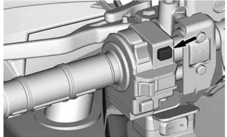
Lorsqu'on appuie sur le bouton et qu'on le tient, le moteur démarre.
