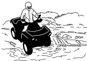
Des freins mouillés réduisent la capacité de freinage. Après être sorti de l'eau, de la neige ou de la boue, actionnez les freins plusieurs fois pour que la chaleur de la friction sèche les freins. Prévoir davantage de distance pour freiner.
