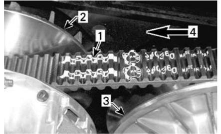
1. Flèche imprimée sur la courroie
