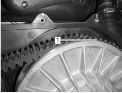
1. Нижняя часть зубцов на одном уровне с внешней поверхностью ремня вариатора
