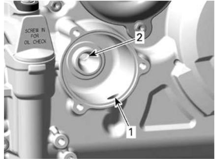
1. Einlass-Bohrung der Ölpumpe zum Ölfilter
