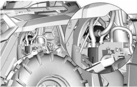
1. Schneiden Sie das Sicherungsband durch, mit dem der runde Filter oben an der Halterung des EVAP-Behälters befestigt ist.
