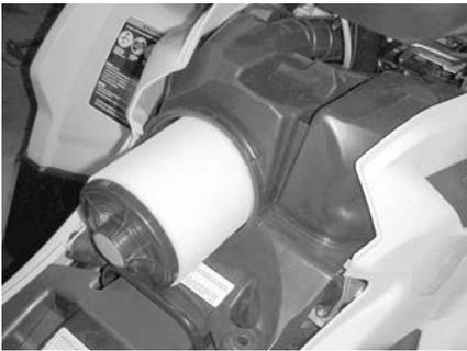
**Untersuchen und Entleeren des Motorluftfilterkastens**
