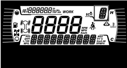
Diese Anzeige zeigt die Getriebestellung an:
