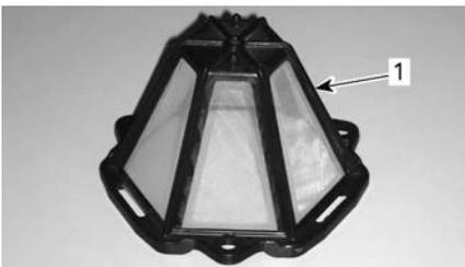
1. Filtro dell'aria CVT (tipo clip-on)
