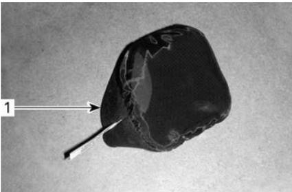
1. Filtro dell'aria CVT (tipo slip-on)
