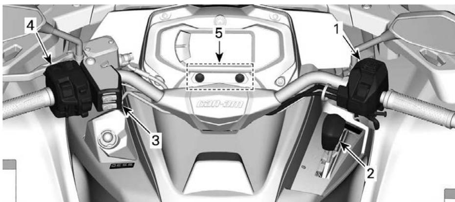
1. Alloggiamento del comando della leva dell'acceleratore
