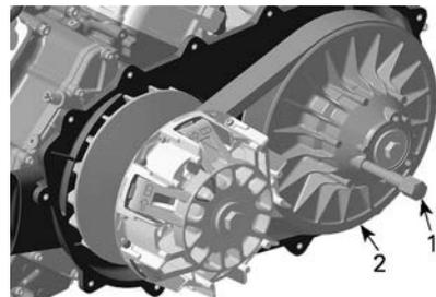
1. Strumento di traino/bloccaggio
