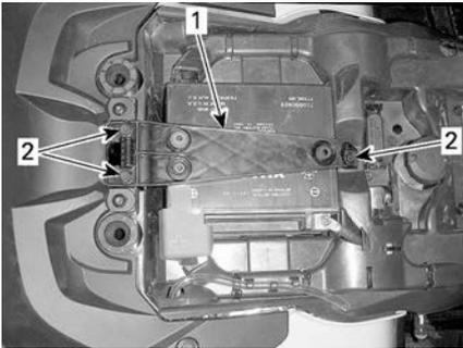
1. Fascetta di fissaggio della batteria
