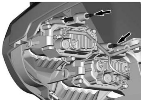
**Remplacement des ampoules des feux arrière**
