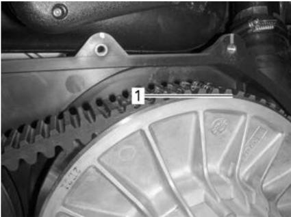
1. Partie la plus basse des pignons alignée avec la surface externe de la courroie d'entraînement
