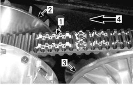
1. Flèche imprimée sur la courroie
