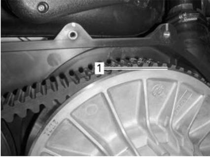
1. Porzione più bassa delle ruote dentate con la superficie esterna della cinghia di trasmissione
