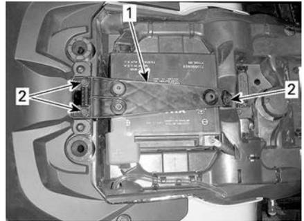
1. Fascetta di fissaggio della batteria
