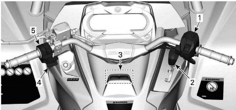
1. Alloggiamento del comando della leva dell'acceleratore
