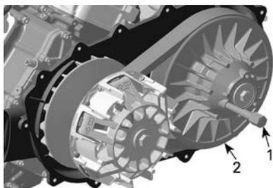
1. Strumento di traino/bloccaggio
