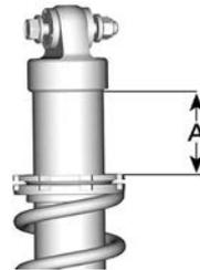
A = FEDERVORSPANNUNG
