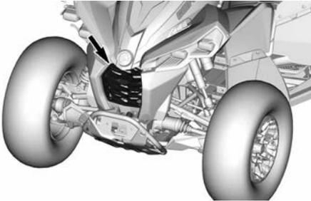
2. Überprüfen Sie den Kühler und die Schläuche auf Undichtigkeiten und andere Beschädigungen.
