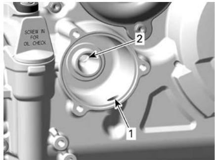
1. Einlass-Bohrung der Ölpumpe zum Ölfilter
