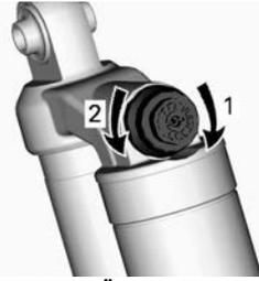
**DRUCKSTUFENDÄMPFUNG - OBEN AM STOßDÄMPFER**
