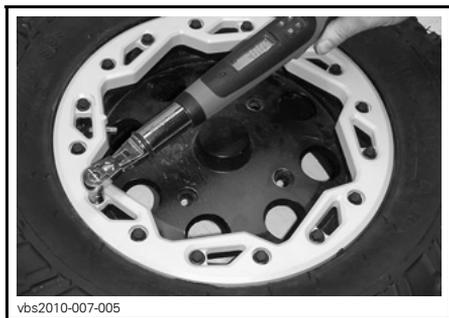
**NOTA:** Es normal que el anillo de la abrazadera del sistema de bloqueo de talón se doble ligeramente para adaptarse al talón de la rueda.
