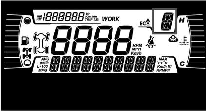
Diese Anzeige zeigt die Getriebestellung an:
