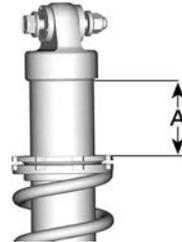
**A = FEDERVORSPANNUNG**
