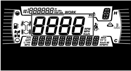
Anzeige der Fahrzeuggeschwindigkeit in km/h oder MPH.
