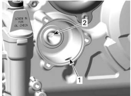
1. Einlass-Bohrung der Ölpumpe zum Ölfilter
