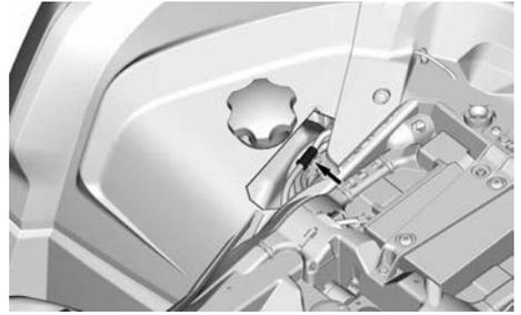
1. Au niveau du passage de roue arrière droit, débranchez les tuyaux du filtre.
