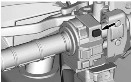
Lorsqu'on appuie sur le bouton et qu'on le tient, le moteur démarre.
