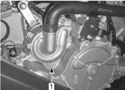
1. Bouchon de vidange du liquide de refroidissement
