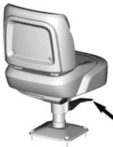
Pour le déverrouiller, tirez la poignée vers le haut et faites pivoter le siège. Pour verrouiller le siège en position, relâchez la poignée et le siège se verrouille dans la position la plus proche (par incréments de 90 degrés).
