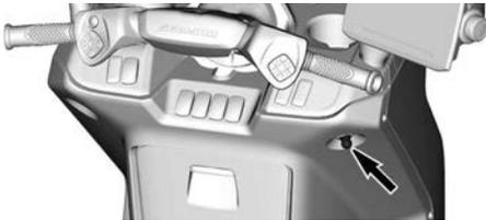
**INTERRUPTEUR DE COUPURE DU MOTEUR**
