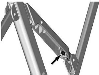
**BOULON DE TENSION BIMINI - CÔTÉ GAUCHE**
