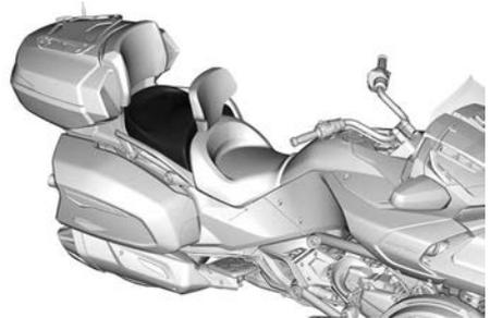
2. Rückenlehne leicht nach vorn ziehen, um sie zu entriegeln, dann anheben und ausbauen.
