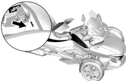
3. Ziehen Sie an der Wartungsabdeckung, um diese vom Fahrzeug abzunehmen.
