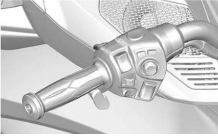
Der Schalter für BRP Connect dient zum direkten Zugriff auf BRP Connect. Mit jeder Betätigung wird zwischen der App-Ansicht und der Funktionsansicht der Multifunktionsanzeige umgeschaltet.
