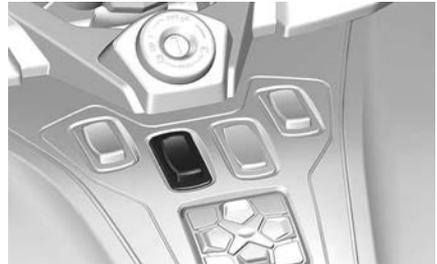
Mit dem Schalter für die beheizbaren Griffe lassen sich die Heizfunktion der beheizbaren Griffe ein- und ausschalten sowie die Heizintensität regulieren.
