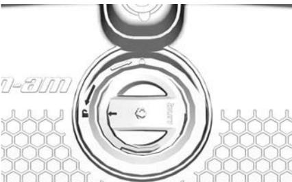
3. Benutzen Sie den hinteren Griff, um das obere Staufach des Fahrzeugs zu entriegeln.
