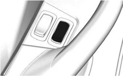
Mit dem Schalter für die Handgriffheizung lässt sich die Heizfunktion der beheizbaren Griffe ein- und ausschalten sowie die Heizintensität regulieren.
