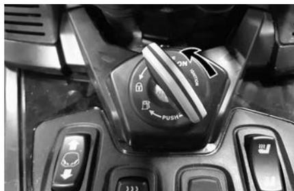
SCHLÜSSELSTELLUNG ZUM ÖFFNEN DES VORDEREN STAUFACHS
