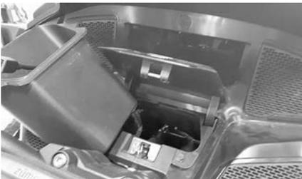
2. Stecken Sie Ihre Hand in die Öffnung und drücken Sie gegen das Schaumstoffteil unter dem Display, um an die Innenseite der Konsole zu gelangen. Es kann erforderlich sein, den Kabelstrang zur Seite zu schieben, um besser arbeiten zu können.
