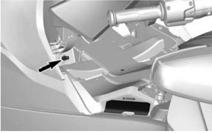
Zum Ändern des Luftdrucks gehen Sie genauso vor wie beim Ändern des Luftdrucks in einem Reifen.
