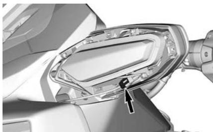
2. Drehen Sie die Schraube am Ende des Spiegelgehäuses heraus.
