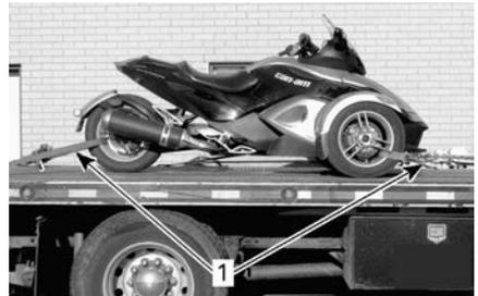
**TYPISCH – FAHRZEUG IST IN RICHTUNG ANHÄNGERVORDERSEITE AUSGERICHTET**
