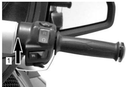
1. Taster zum Fortsetzen (RESUME) der Geschwindigkeitsregelung nach oben schieben
