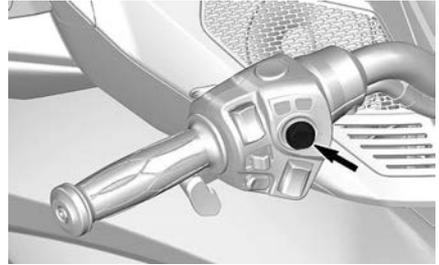
Das ECC ist ein Multifunktions-Schalter, es ermöglicht die Steuerung zahlreicher Funktionen des Multifunktions-Anzeigeinstruments.
