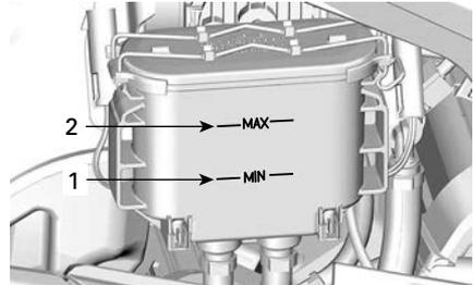
1. Markierung für max. Bremsflüssigkeitsstand
