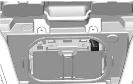
6. Schließen Sie zunächst ein Ende des ROTEN Überbrückungskabels an den Pluspol (+) der entladenen Batterie an.
