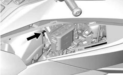
12. Nehmen Sie beide Bremsflüssigkeitsstandscharter vom Boden des Behälters ab.
