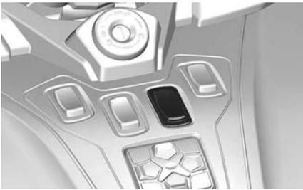
Stelle für den Schalter, wenn ein Zusatzscheinwerfer eingebaut wird.
