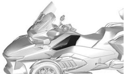
Die linke Wartungsabdeckung muss abgenommen werden, um an den Luffilter des Motors zu gelangen.
