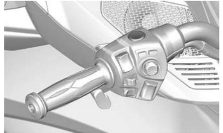
Halten Sie den Rückwärtsgang-Schalter gedrückt, um in den Rückwärtsgang zu schalten. Siehe Abschnitt *Rückwärts fahren* in *Grundlegende Verfahren* mit weiteren Anweisungen.
