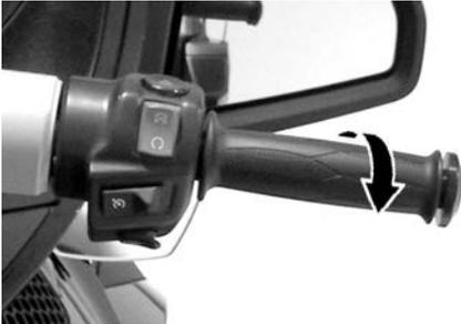
**ERHÖHUNG DER MOTORDREHZAHL**
