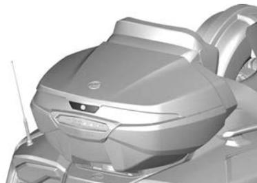
Ziehen Sie den Schließmechanismus hoch, um die Abdeckung zu öffnen. Ist das Fach verriegelt, entriegeln Sie es mit dem Zündschlüssel.
