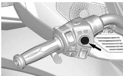
Durch Drücken des Joysticks (mittlere Taste) wird die Menüauswahl rechts aktiviert, in dieser Reihenfolge:
