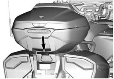
4. Heben Sie das Staufach leicht an und schieben Sie Ihre Hand darunter, um den Steckverbinder neben dem Mitfahrersitz abzuziehen.
