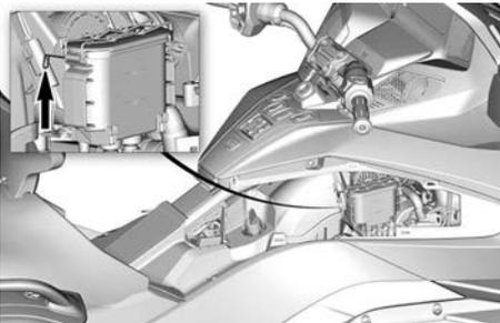
14. Schieben Sie den Behälter nach hinten und sichern Sie ihn mit einem Gummizug am Lenker.
