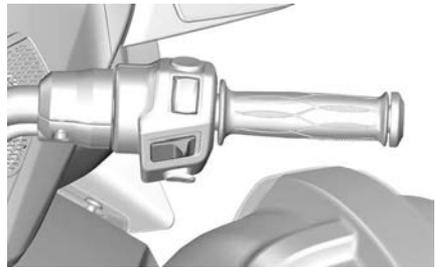
Bei dem Schalter handelt es sich um einen Multifunktionsschalter. Die Geschwindigkeitsregelung kann damit aktiviert, eingestellt und ausgeschaltet werden.
