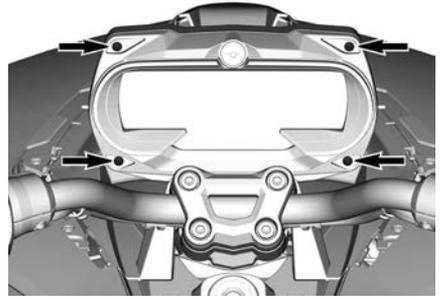
6. Apriete las pestañas de sujeción para quitar el indicador y desconecte el conector.
