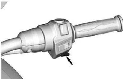
Cuando se presiona y se mantiene el tiempo necesario, arranca el motor.
