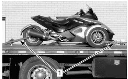
**TÍPICO - VEHÍCULO ORIENTADO HACIA EL REMOLQUE**
