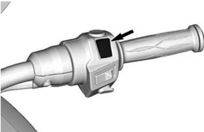
El interruptor tiene dos posiciones y se tiene que configurar a la posición funcionar antes de que pueda arrancar el motor. Este interruptor le permite detener el motor en cualquier momento sin retirar la mano del manillar.
