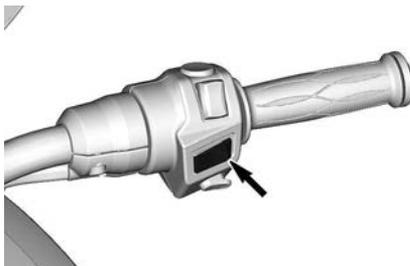
El interruptor es multifuncional. Permite activar, ajustar y detener el funcionamiento del control de velocidad de crucero.
