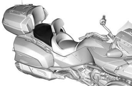
2. Tire ligeramente del respaldo del asiento hacia delante para desbloquearlo y levántelo para retirarlo.
