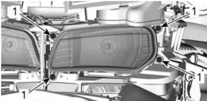
1. Tornillo de sujeción del faro
