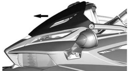
3. Afloje el tornillo de sujeción inferior de la punta de la consola.
