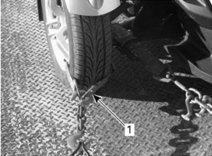
**COLOCACIÓN DE LAS RUEDAS DELANTERAS — TÍPICO MÉTODO 1**
