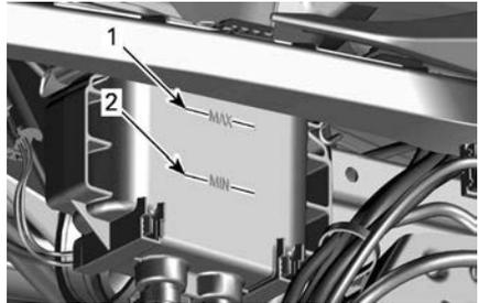
1. Marca de nivel MÁXIMO del líquido de frenos
