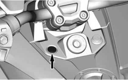
El botón de empuñadura con calefacción permite encender y apagar las empuñaduras con calefacción.'
