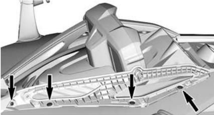
3. Afloje el tornillo de sujeción inferior de la punta de la consola.
