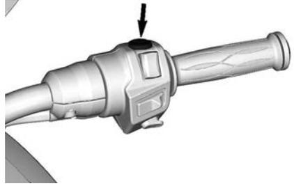
Pulse el botón para encender o apagar las luces de emergencia.
