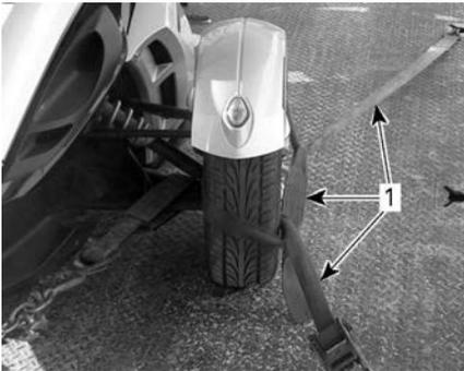
**COLOCACIÓN DE LAS RUEDAS DELANTERAS — TÍPICO MÉTODO 2**
