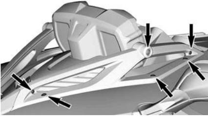
2. Retire los tornillos de sujeción que fijan las guías superiores al vehículo.
