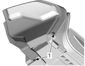
1. Tornillos de sujeción de la parte inferior
