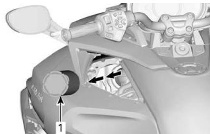
TÍPICO - RETIRE EL FILTRO DE AIRE DEL SILENCIADOR DE LA ENTRADA DE AIRE.
