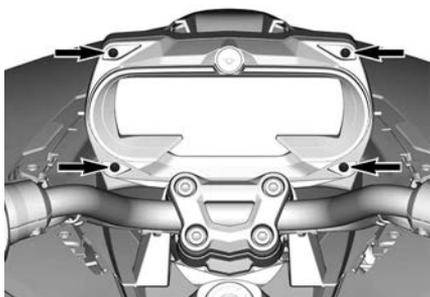
6. Apriete las pestañas de sujeción para quitar el indicador y desconecte el conector.
