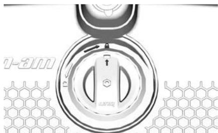
6. ストレージコンパートメントをしっかりとつかみ、車両に正しく取り付けられ、ロックされているか確認します。
