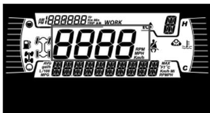
Anzeige der Fahrzeuggeschwindigkeit in km/h oder MPH.
