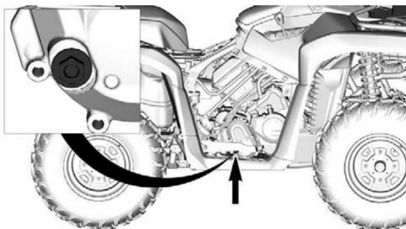
7. Lassen Sie das Öl vollständig aus dem Getriebe ablaufen.
