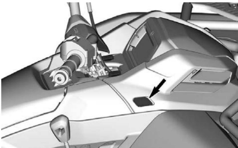
3. Lösen Sie beide Verriegelungsglaschen an den Seiten der Lenkung.
