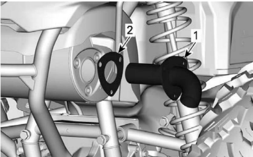
1. Abgasendrohr mit Funkenschutz
