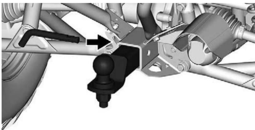
3. Sichern Sie den Stift durch Einklappen der Verriegelung.
