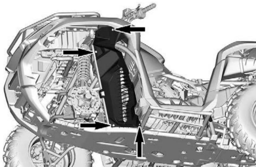
3. Entfernen Sie die linke vordere Fußstütze.
