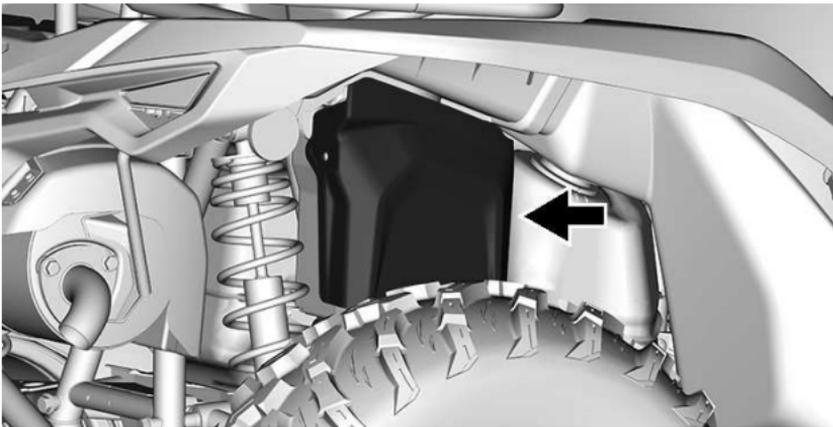
5. Sichern Sie die Batterieabdeckung mit zwei (2) Kunststoffnieten.
