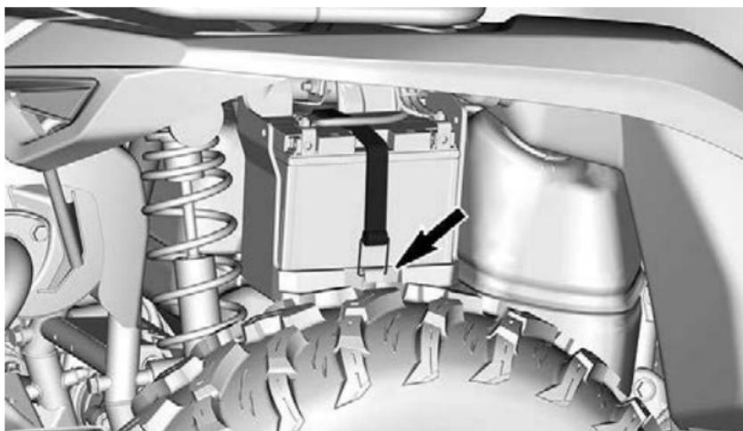
3. Schließen Sie zuerst den Kontakt des ROTEN (+) Kabels und danach den des SCHWARZEN (-) Kabels an.
