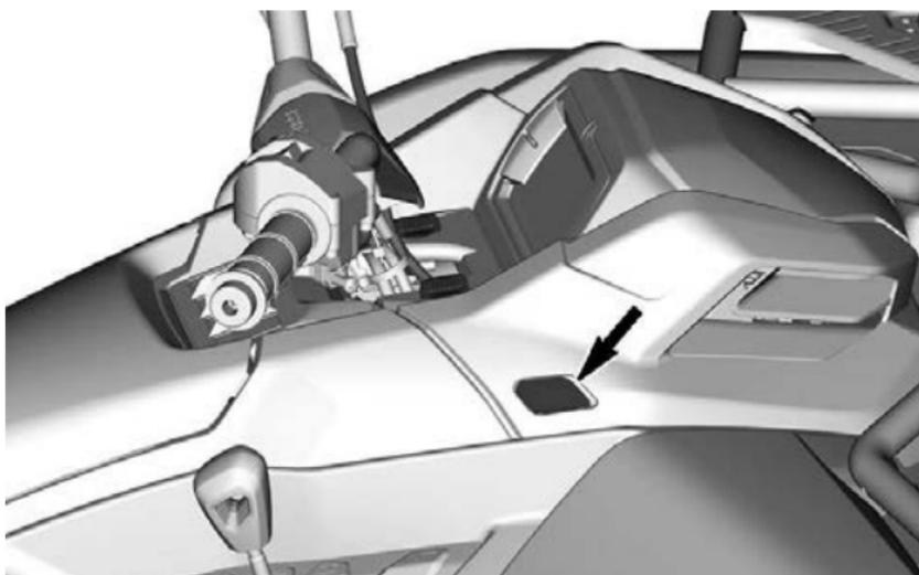
4. Sichern Sie die Konsole durch zwei (2) Vierteldrehungen.
