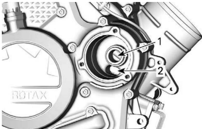
1. Auslass-Bohrung zur Ölspeisung des Motors
