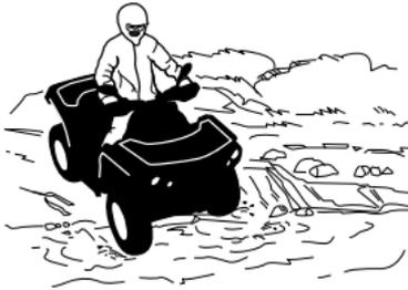
Nasse Bremsen beeinträchtigen die Bremsleistung Ihres Fahrzeugs. Sorgen Sie durch mehrfaches Betätigen dafür, dass Ihre Bremsen wieder trocken werden, nachdem das Fahrzeug das Wasser, Schlamm oder Schnee verlassen hat. Achten Sie beim Bremsen auf einen größeren Abstand.
