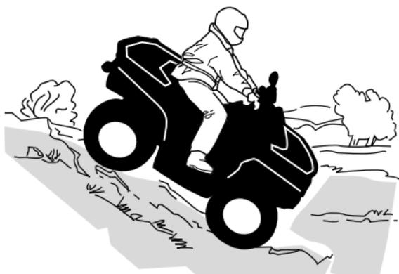
Maintenez le poids de votre corps vers l'arrière. Restez assis. Freinez graduellement pour éviter de glisser. En descente, ne ralentissez pas avec la compression du moteur et ne mettez pas le véhicule au point mort.
