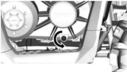
2. Remettez en place le bouchon de vidange hexagonal fendu de 15 mm (19/32 po).
