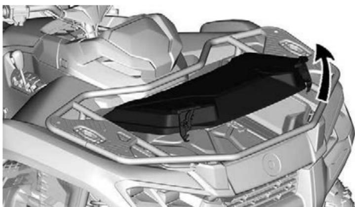
2. Tournez le levier situé à l'intérieur du compartiment de rangement pour verrouiller le couvercle en position ouverte.
