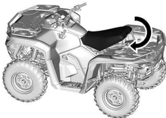
3. Vérifiez que le siège est bien fixé en tirant sur l'avant pour confirmer qu'il est bien verrouillé.
