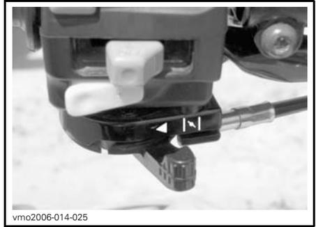
**TYPICAL — CHOKE LEVER IN THE OFF POSITION**
