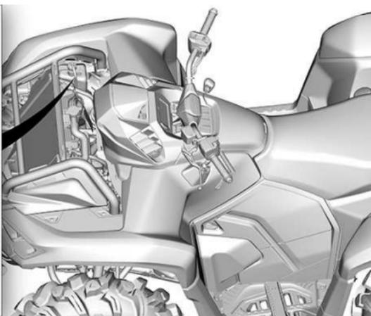
Per aggiungere liquido refrigerante nel sistema, rimuovere il tappo di pressione del sistema di raffreddamento.
