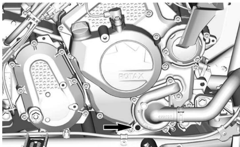
3. Per completare il totale svuotamento del sistema di raffreddamento, scollegare il flessibile del radiatore inferiore dal coperchio della pompa dell'acqua e scaricare il refrigerante rimasto in un apposito contenitore.
