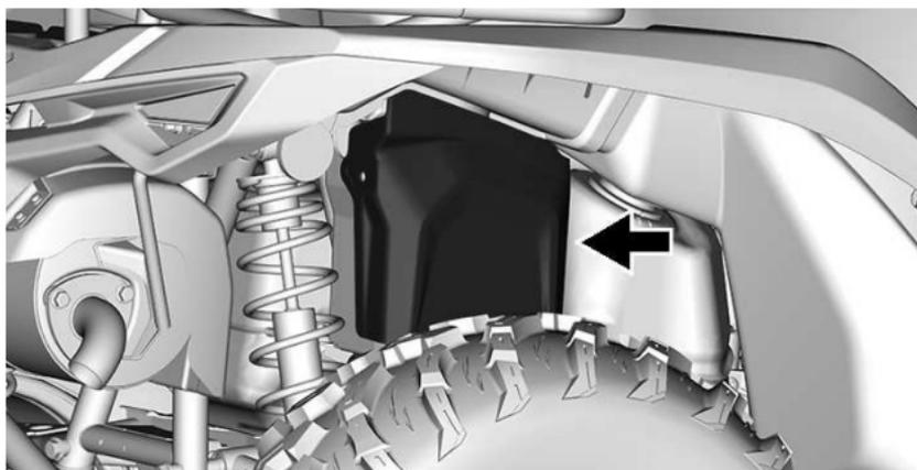
5. Fissare la copertura della batteria con due (2) rivetti di plastica.
