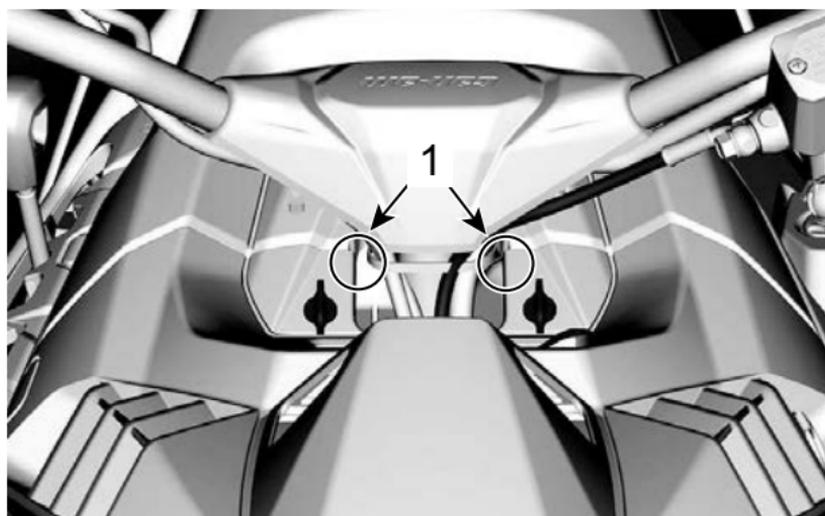
1. Posizione della linguetta di bloccaggio
