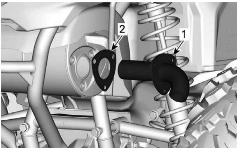
1. Tubo di coda di scarico con parascintille
