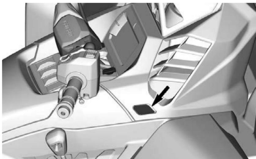
3. Sganciare entrambe le linguette di bloccaggio ai lati dello sterzo.
