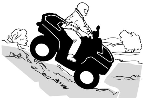
Spostare il peso del corpo all'indietro. Restare seduti. Frenare gradualmente per evitare il pattinamento. Non scendere in "folle" utilizzando la sola compressione del motore.
