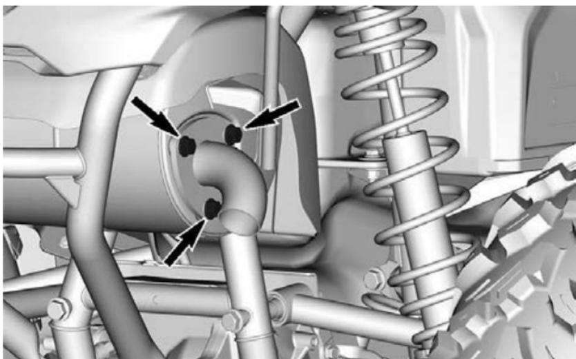
2. Rimuovere il tubo di coda di scarico con il parascintille e la guarnizione (smaltirlo).
