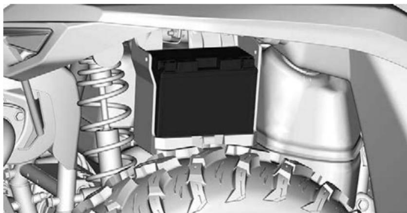
2. Bloccare la batteria con la fascetta di fissaggio.
