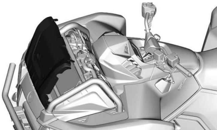
2. Se il veicolo si trova su una superficie piana, il livello del liquido dovrebbe essere compreso tra le tacche di MIN e MAX del serbatoio liquido refrigerante.
