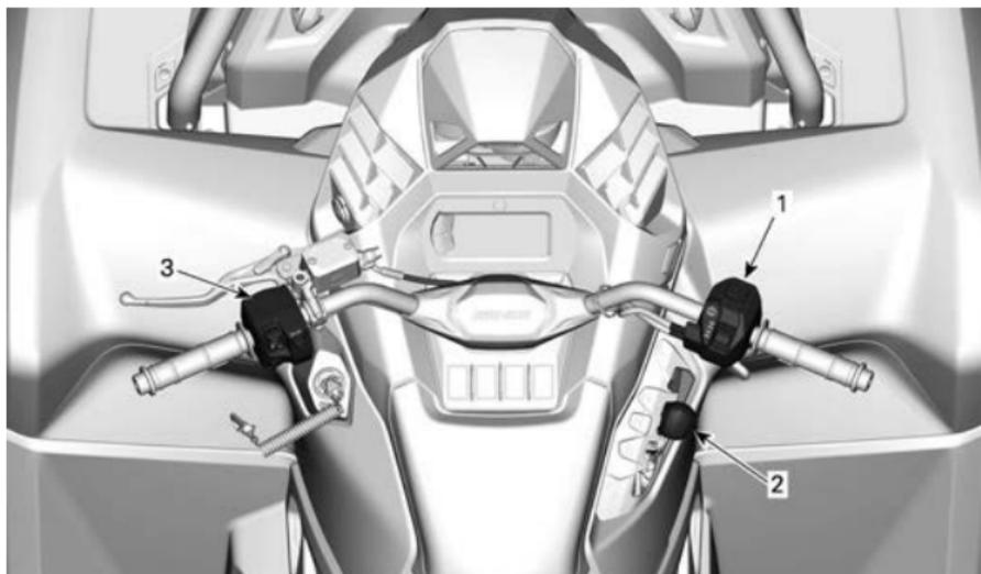
1. *Alloggiamento del comando della leva dell'acceleratore*
