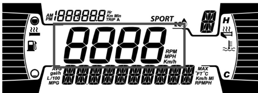
Indique le régime (tr/min) du moteur ou la vitesse (km/h ou mi/h) du véhicule.
