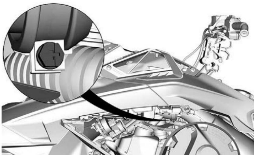
10. Retirez les vis de fixation du module de carrosserie supérieur des deux côtés.
