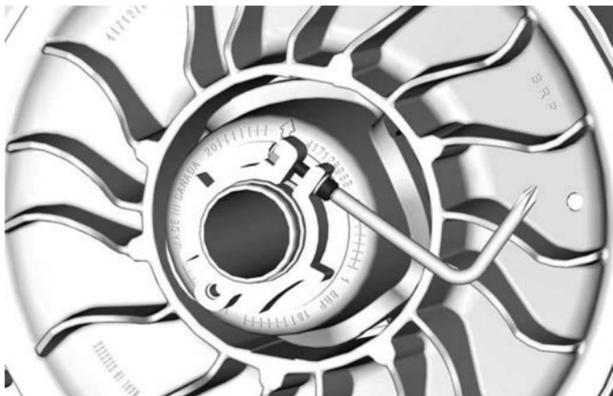
2. À l'aide de l'outil de réglage de la suspension fourni, faites tourner l'anneau d'un quart de tour à la fois puis faites tourner la poulie réceptrice de manière à installer correctement la courroie entre les roues de la poulie.
