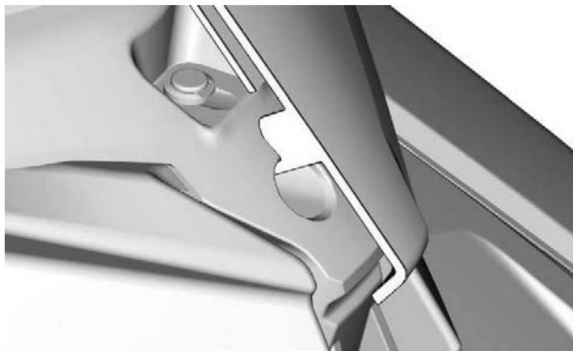
3. Fixez le pare-brise en insérant les goupilles du pare-brise dans les œillets.
