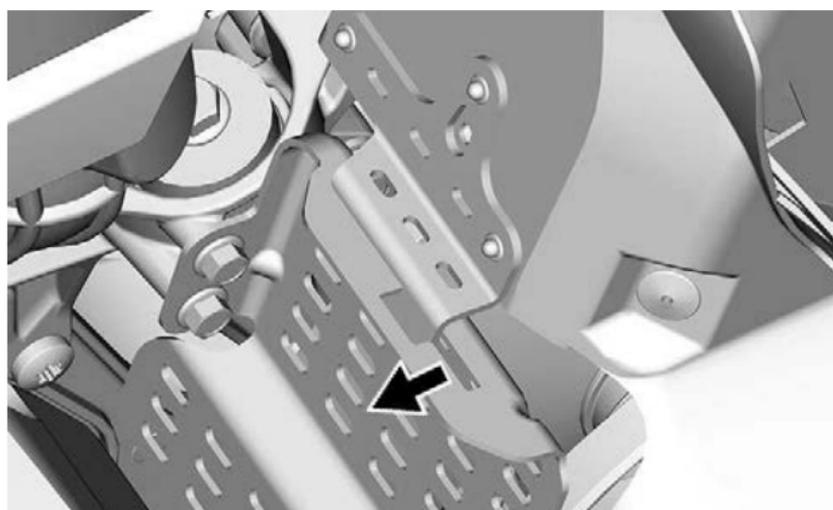
3. Insérez la languette de protection de la courroie entre le plateau inférieur et le crochet.
