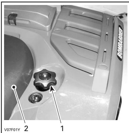
1. Bouchon du réservoir
