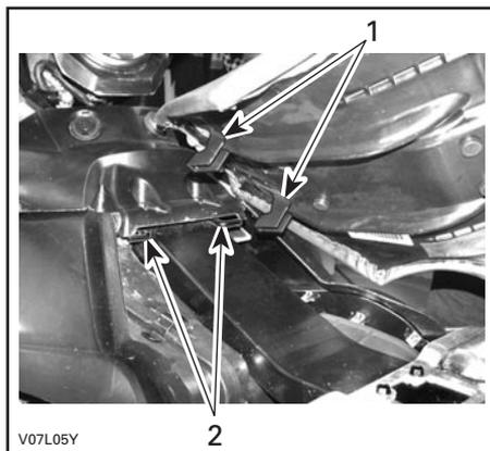
1. Insérer ces languettes dans le crochet
