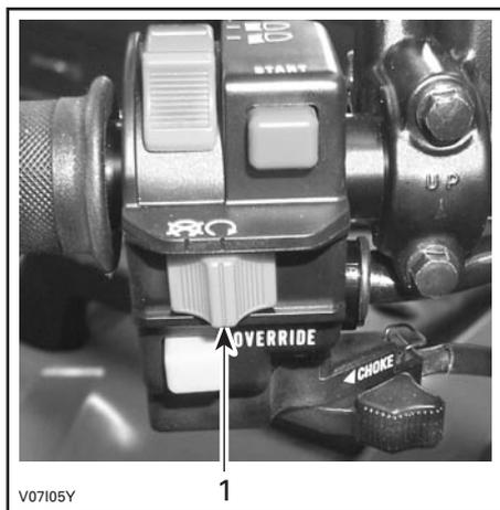
1. Interrupteur d'arrêt du moteur
