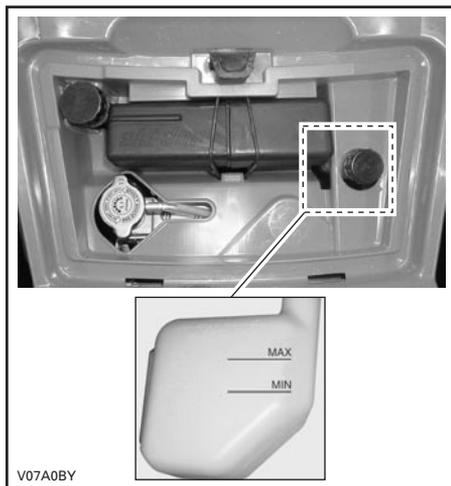
Le véhicule sur une surface de niveau, le niveau de liquide doit se trouver entre les marques MIN. et MAX. du réservoir.
