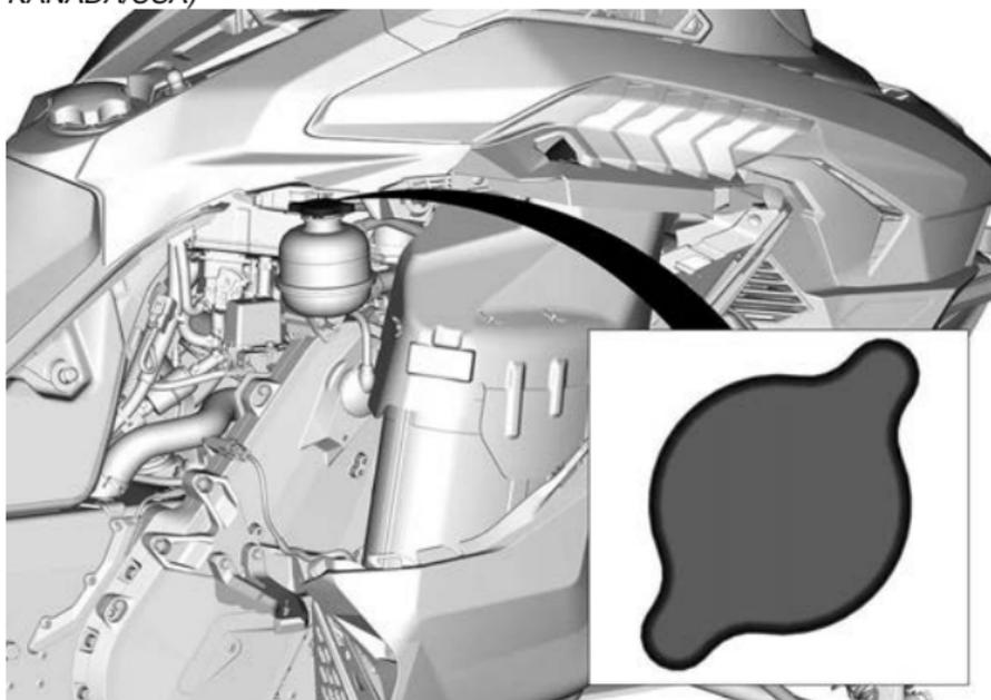
**TYPISCH – POSITION DES SCHILDS – AUßER TURBOMOTOR**
