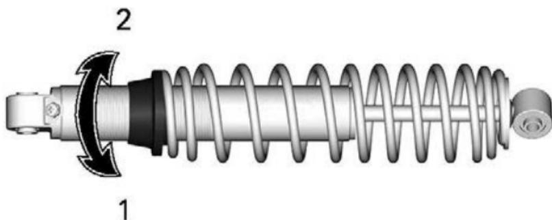
1. *Vorspannung erhöhen*
