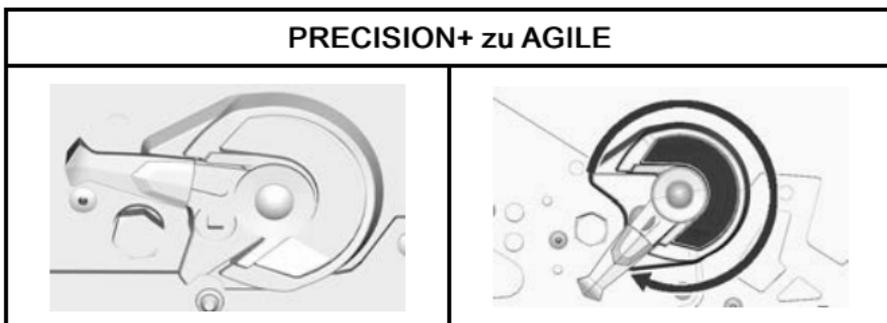
Werkseitig ist der verstellbare Arretierriemen so eingestellt, dass die „AGILE“-Stellung der Einstellung Nr. 4 am regulären Arretierriemen entspricht. Die „PRECISION+“-Stellung entspricht der Einstellung Nr. 7 am regulären Arretierriemen.
