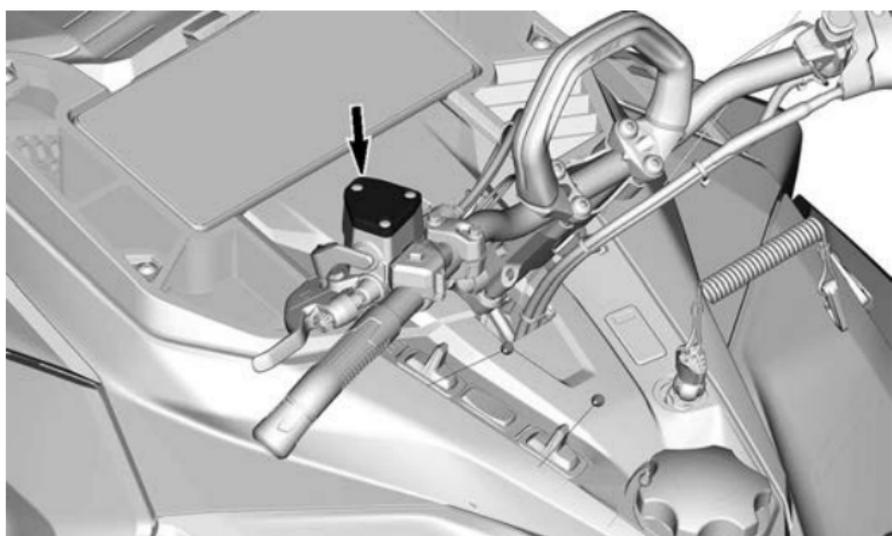
2. Entfernen Sie die Halteschrauben des Behälterdeckels.
