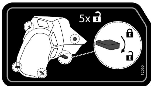
**SEITENVERKLEIDUNG LINKS – SCHILD RIEGEL**
