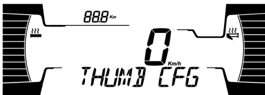
3. Verwenden Sie den Konsolenschalter, um das Gleichgewicht der beheizten Griffe zwischen dem Daumen und den auf dem rechten Display angezeigten Griffen einzustellen.
