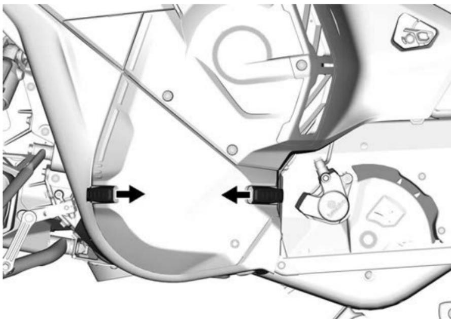
2. Entfernen Sie die obere linke Seitenverkleidung.
