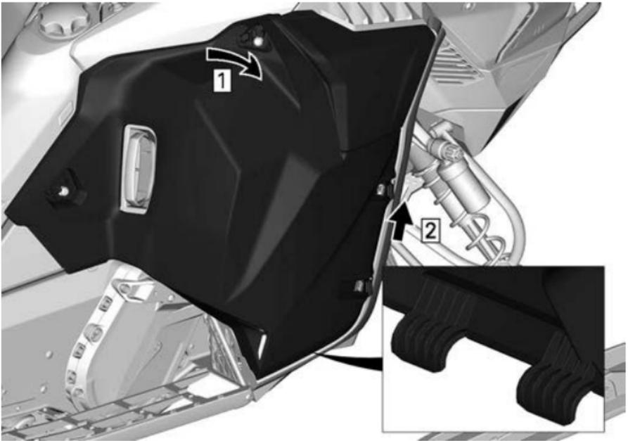
Schritt 1. Seitenverkleidung schwenken
