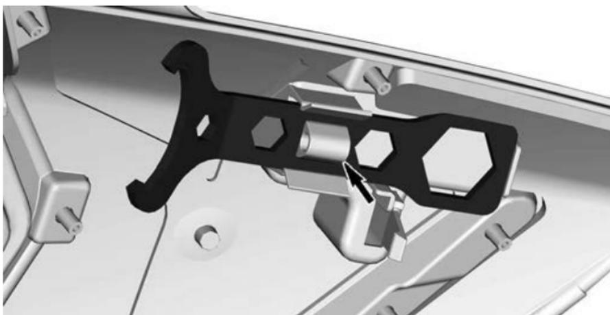
2. Schieben Sie den Scheiben-Expander und die Scheinwerfereinstellvorrichtung am kurzen Ende in das Loch.
