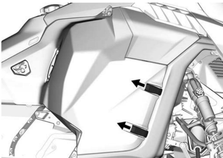
2. Schwenken Sie die Seitenverkleidung und schieben Sie sie.
