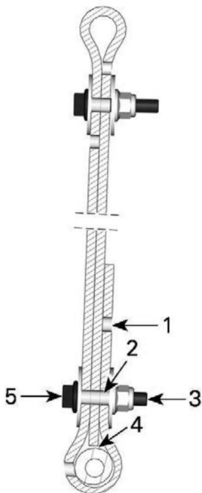
**EINSTELLBARE LÄNGE DES ANPASSBAREN ARRETIERRIEMENS (2. BOHRUNG)**
