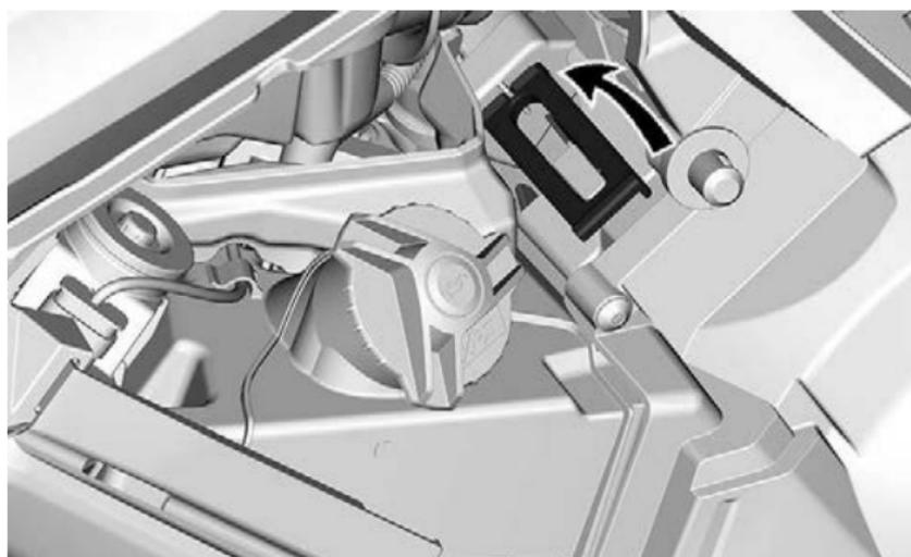
4. Lösen Sie die Sicherheitsverriegelung des Riemenscheibenschutzes und schieben Sie die Verkleidung nach außen.
