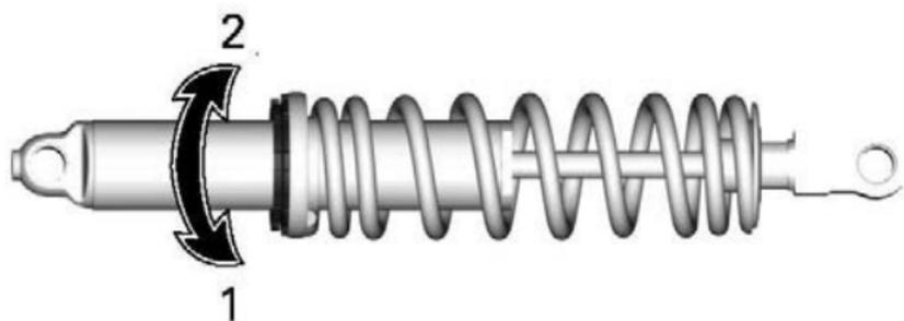
1. Vorspannung erhöhen
