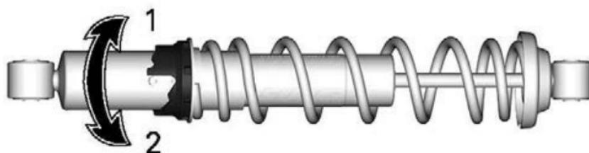
1. Vorspannung erhöhen
