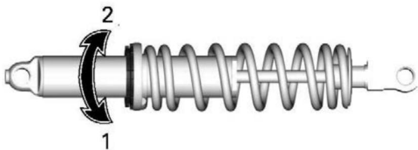
1. Vorspannung erhöhen
