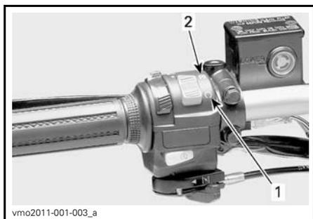
**TYPIQUE - INTERRUPTEUR D'ARRÊT D'URGENCE DU MOTEUR**
