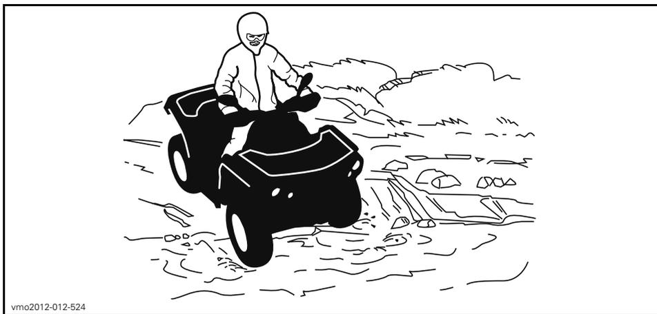
Des freins mouillés réduisent la capacité de freinage. Après être sorti de l'eau, de la boue ou de la neige, rouler à basse vitesse et actionner les freins quelques fois pour que la chaleur de la friction sèche les plaquettes.
