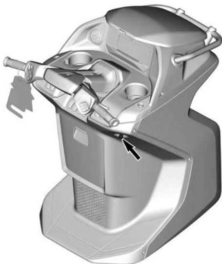
**INTERRUPTEUR DE COUPURE DU MOTEUR**
