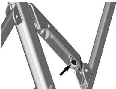
**BOULON DE TENSION BIMINI - CÔTÉ GAUCHE**
