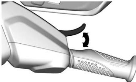
Le levier iTC est retenu par un ressort et revient en position de repos (ralenti) lorsqu'il n'est pas actionné.
