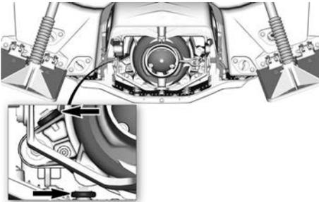
Vérifier si l'anode est usée. Si l'usure dépasse la moitié de l'anode, la faire remplacer par un concessionnaire autorisé d'embarcations Sea-Doo.
