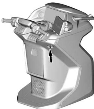
**INTERRUPTEUR DE COUPURE DU MOTEUR**
