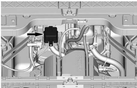
Pour retirer le couvercle de la boîte à fusibles, appuyez sur les languettes de verrouillage ensemble, tirez sur le couvercle de la boîte à fusibles pour l'ouvrir.
