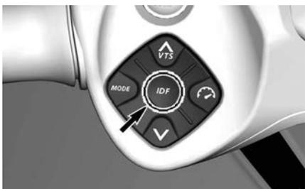
Il permet d'activer le système iDF. Reportez-vous à la section *Activation du système de pompe anti-débris intelligent (iDF)* dans la section *Instructions d'utilisation*.
