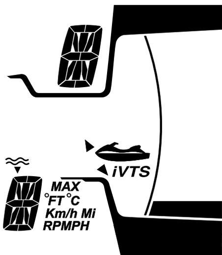
La position d'assiette intermédiaire doit être sélectionnée en fonction de la position d'assiette réelle. Double-cliquez sur le bouton HAUT VTS si la position est en dessous de l'assiette intermédiaire ou double-cliquez sur le bouton BAS VTS si la position est au dessus de l'assiette intermédiaire.
