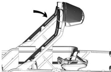
3. Placez la housse Bimini roulée dans le compartiment avant du Bimini.
