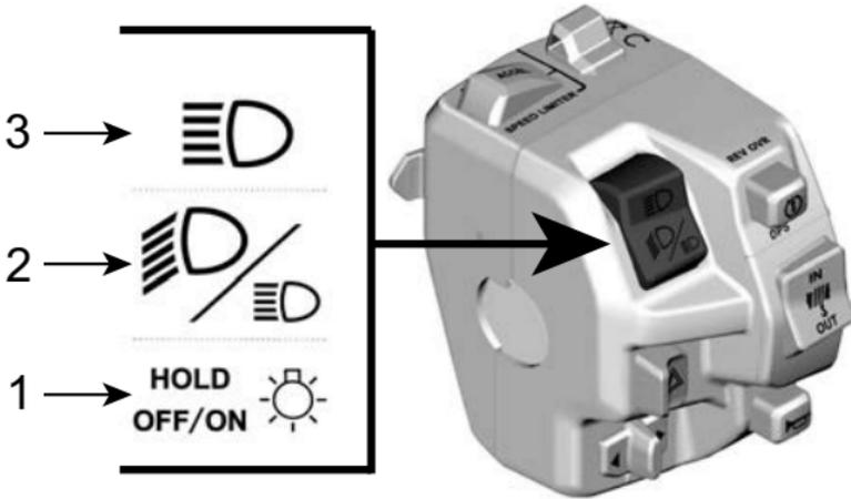
1. Reductor de luz/Faro apagado (OFF)
