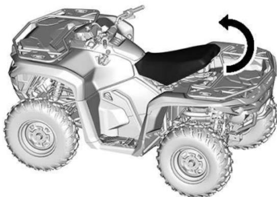
3. Continúe levantando el asiento hasta que pueda liberar el dispositivo de retención de la parte delantera y, a continuación, retire el asiento.
