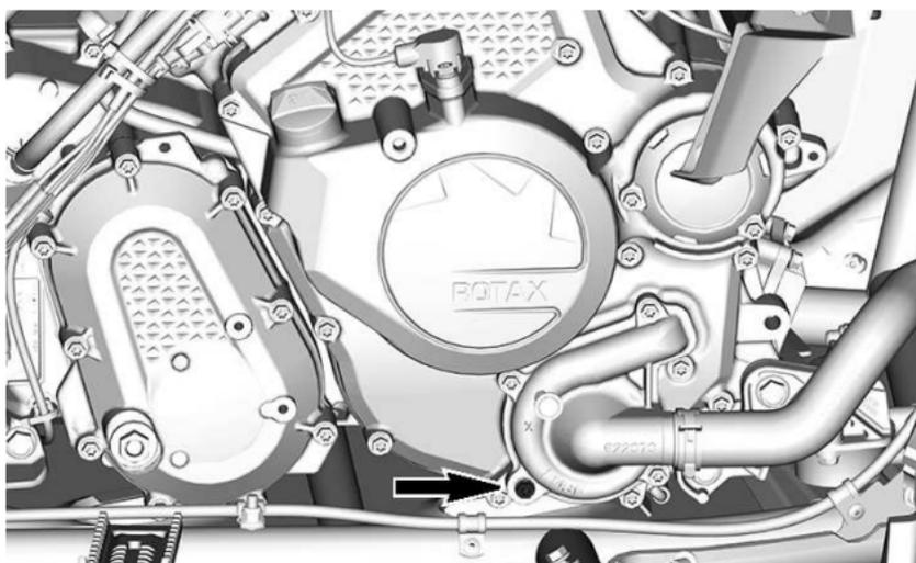
3. Desconecte la manguera inferior del radiador, de la cubierta de la bomba de agua y vacíe el refrigerante que quede en un recipiente adecuado.
