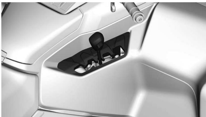
La palanca de cambios se utiliza para cambiar de marcha.
