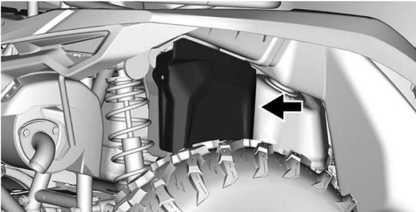
5. Asegure la cubierta de la batería utilizando dos (2) remaches plásticos.
