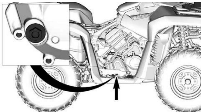
5. Compruebe el nivel de aceite. El aceite debería estar a ras de la parte inferior del orificio del nivel de aceite.
