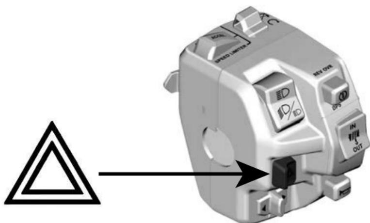
Pulse el botón hacia el lado para encender las luces de emergencia. Púselo hacia el otro lado para apagarlas.
