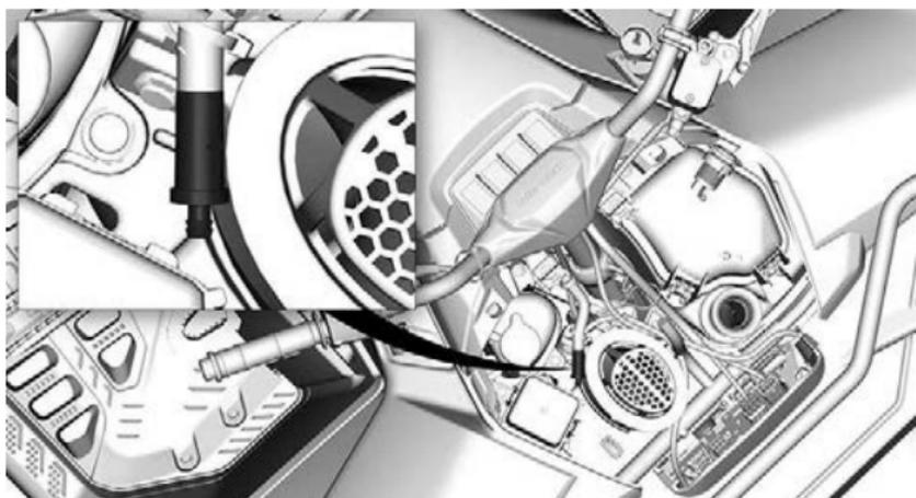
1. Desconecte las mangueras del filtro, por el lado derecho de la consola.
