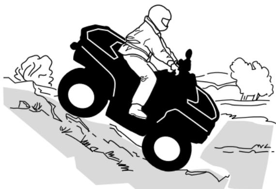
Incline el peso del cuerpo hacia atrás. Permanezca sentado. Frene gradualmente para evitar deslizamientos. No descienda la pendiente únicamente con el freno motor o en punto muerto (N).
