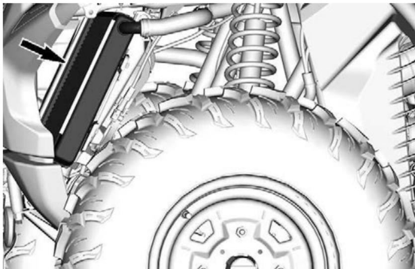
1. Retire ambos deflectores de aire delanteros, situados en los costados del radiador.
