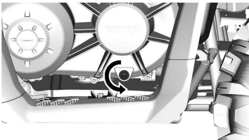
2. Instale de nuevo el tapón de drenaje hexagonal ranurado 15 mm (19/32 pulg).
