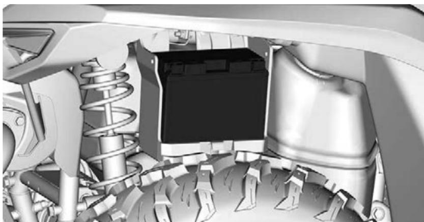
2. Asegure la batería con la correa de sujeción que trae.
