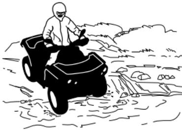
Si los frenos están húmedos, la capacidad de frenado del vehículo se ve afectada. Asegúrese de que se sequen los frenos; para ello, acciÓnelos varias veces después de salir del agua, del barro o de la nieve con el vehículo. Tenga en cuenta la necesidad de una mayor distancia para el frenado.
