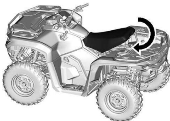
3. Compruebe que el asiento está seguro mediante un tirón, y halando de la parte delantera para confirmar que se ha bloqueado correctamente.
