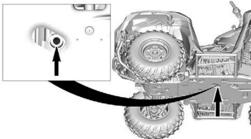
4. Coloque una bandeja de drenaje debajo del área del tapón de drenaje de aceite.
