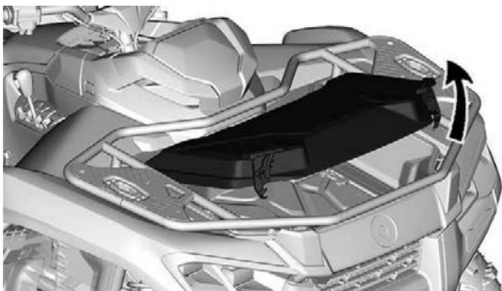
2. Gire la palanca que se encuentra dentro del compartimento, para asegurar la tapa en posición abierta.
