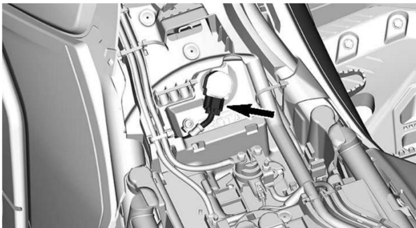
3. Extraiga la bobina de encendido.
