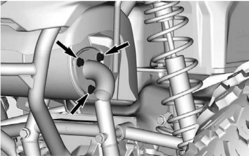
2. Retire el tubo de escape junto con el supresor de chispa y la junta.
