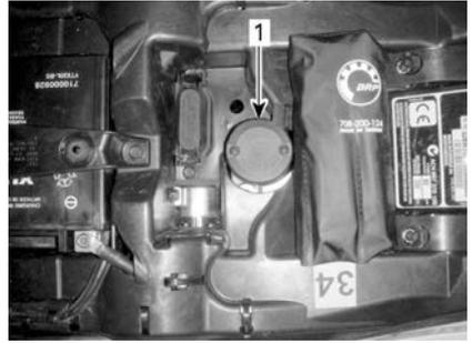
1. Behälter für Bremsflüssigkeit der hinteren Bremse
