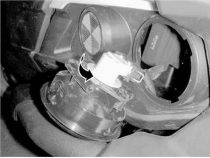
4. Zur Installation wird das Ausbauverfahren in umgekehrter Reihenfolge angewandt.
