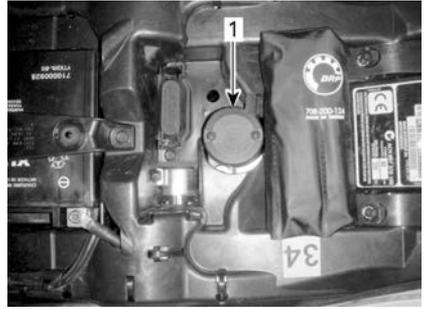
1. Behälter für Bremsflüssigkeit der hinteren Bremse
