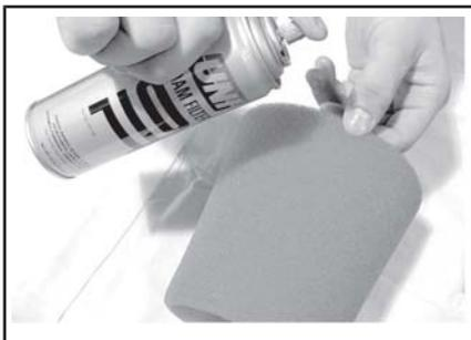
*SITUAZIONE TIPICA - LUBRIFICARE L'ELEMENTO FILTRANTE IN MATERIALE ESPANSO*
