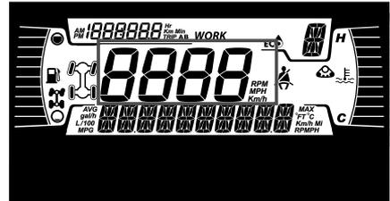
Anzeige der Fahrzeuggeschwindigkeit in km/h oder MPH.
