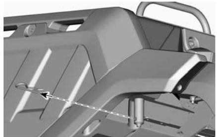
4. Entfernen Sie an beiden Seiten die Verriegelungsgriffe.
