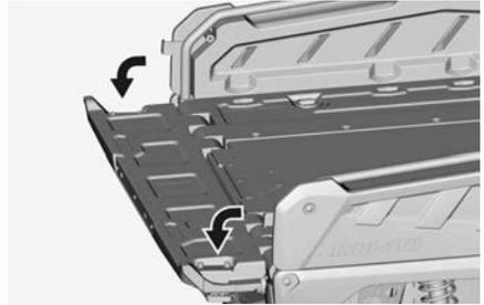
3. Entfernen Sie an beiden Seiten die Federstecker der Verriegelungsgriffe.
