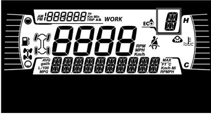
Diese Anzeige zeigt die Getriebestellung an:
