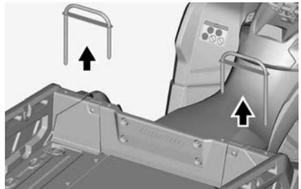
5. Heben Sie die Seitenwand hoch und entfernen Sie sie.
