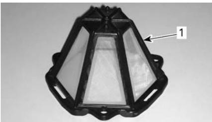
1. Filtro dell'aria CVT (tipo clip-on)
