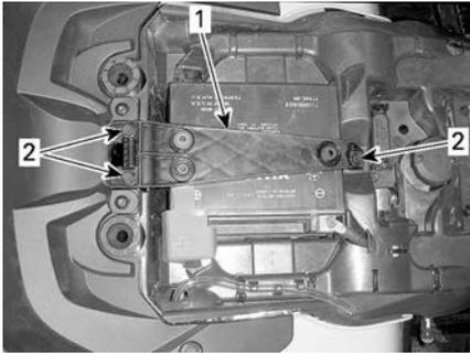
1. Fascetta di fissaggio della batteria
