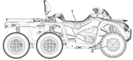
1. Etichetta NRMM - Sul telaio sotto il sedile
