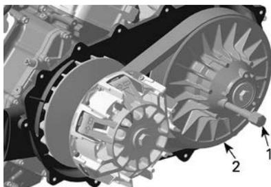
1. Strumento di traino/bloccaggio
