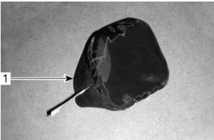
1. Filtro dell'aria CVT (tipo slip-on)
