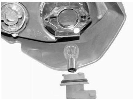
4. Seguire la procedura di rimozione al contrario per installare la nuova lampadina.
