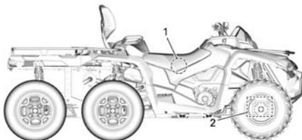
1. Etichetta VIN - Sul telaio sotto il sedile
