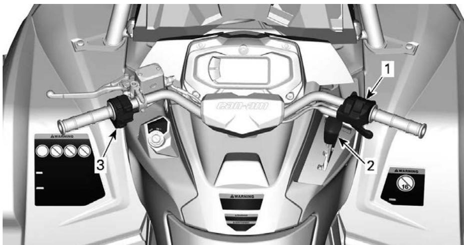
1. Alloggiamento del comando della leva dell'acceleratore
