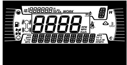
Anzeige der Fahrzeuggeschwindigkeit in km/h oder MPH.
