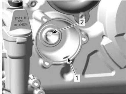
1. Einlass-Bohrung der Ölpumpe zum Ölfilter
