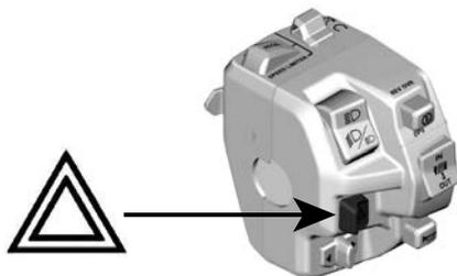
Poussez l'interrupteur vers le côté pour allumer les feux de détresse. Poussez-le de l'autre côté pour l'éteindre.
