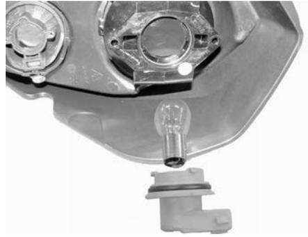
4. Inversez la procédure de dépose pour installer la nouvelle ampoule.
