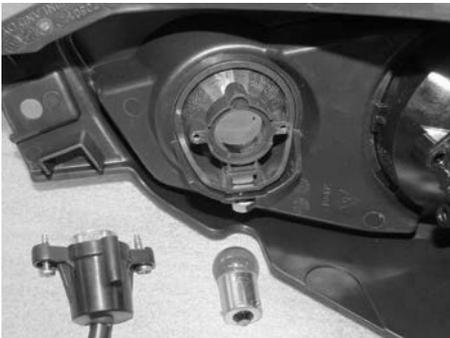
4. Inversez la procédure de dépose pour installer la nouvelle ampoule.
