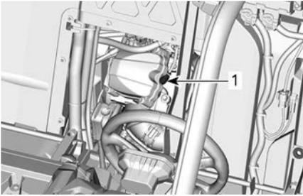
1. Vela de ignição dianteira do motor V-twin
