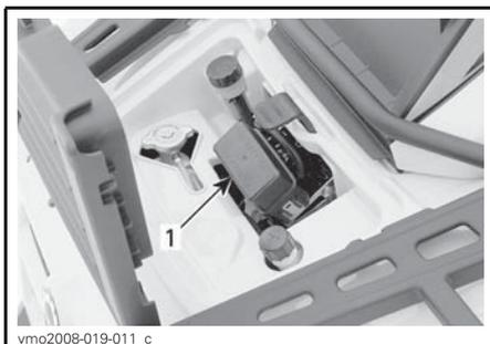
1. Bloque de fusibles de la parte delantera
