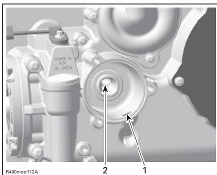
1. Orificio de salida al sistema de suministro de aceite al motor
