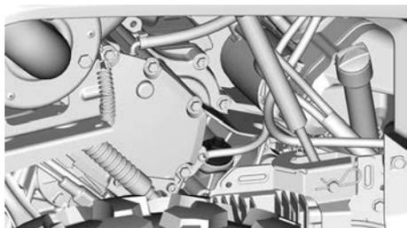
3. Coloque um recipiente de drenagem embaixo do bocal de drenagem do óleo.
