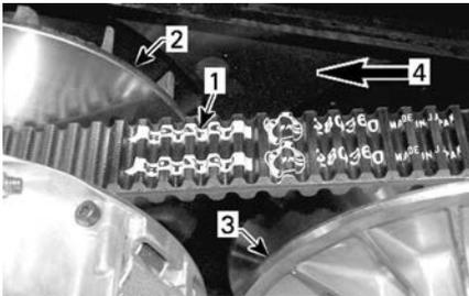
1. Flèche imprimée sur la courroie
