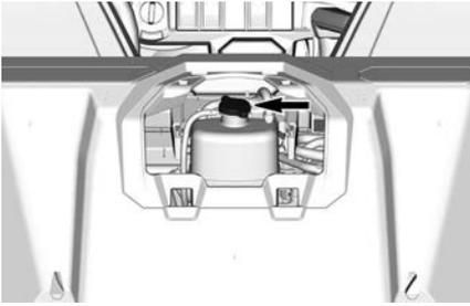
2. Ajoutez du liquide de refroidissement dans le système lorsque nécessaire. Utilisez un entonnoir pour éviter de renverser du liquide. **Évitez tout remplissage excessif.**
