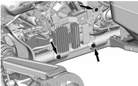
**VIS DE SUPPORT DE RÉGULATEUR/TENSION**
