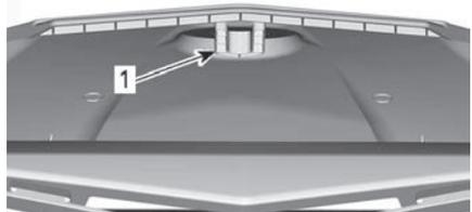
1. Positionnement de la fente sur le dessous du couvercle
