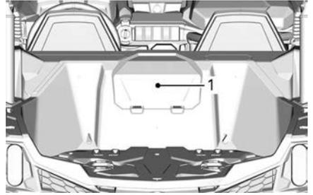
1. Couvercle d'accès au réservoir du liquide de refroidissement
