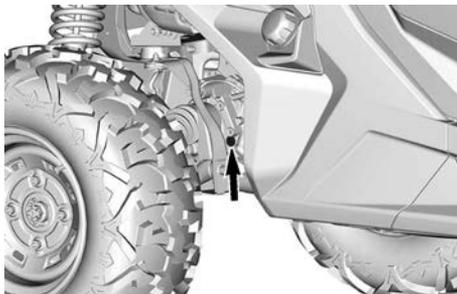
3. Retirez le bouchon de remplissage.
