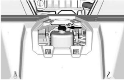
2. Adicione líquido de arrefecimento no sistema se necessário. Use um funil para não derramar. **Não complete além da capacidade.**
