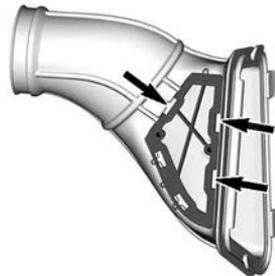
6. Rimozione del filtro dell'aria CVT.
