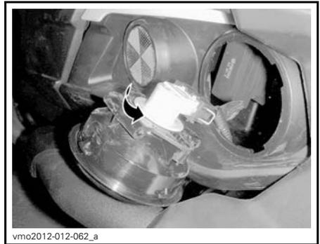
**ROTATE BULB COUNTERCLOCKWISE**
