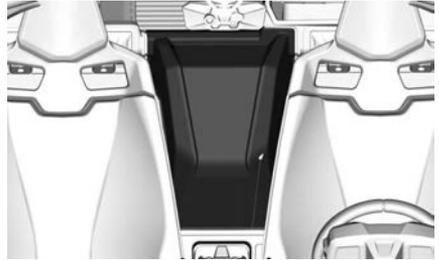
Remova os parafusos de retenção dianteiros da placa protetora.
