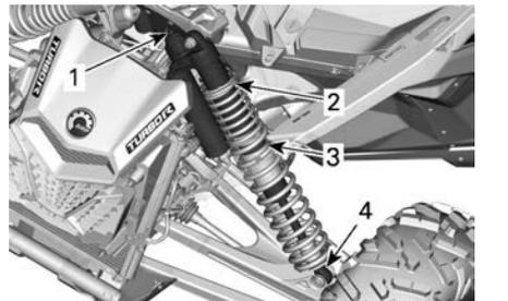
**TÍPICO - COM AMORTECIMENTO DO REBOTE - SUSPENSÃO DIANTEIRA**
