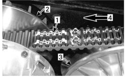
1. Flèche imprimée sur la courroie
