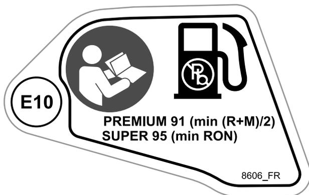
À L'INTÉRIEUR DU COUVERCLE DU BOUCHON DU RÉSERVOIR D'ESSENCE
