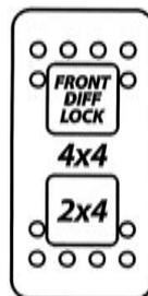
Ce sélecteur permet de sélectionner le mode 2 ou 4 roues motrices lorsque le véhicule est arrêté et que le moteur est en marche.
