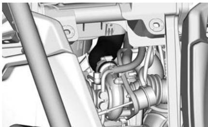
Ouvrez le refroidisseur intermédiaire et le support du tuyau de carter en retirant la vis.
