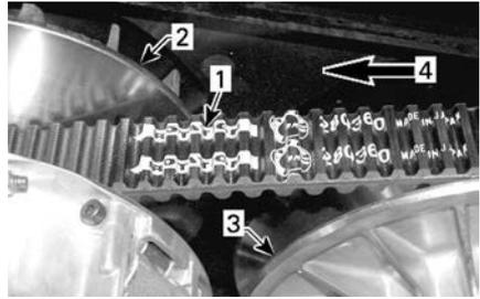
1. Flèche imprimée sur la courroie
