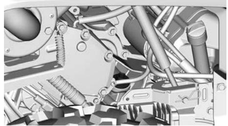
3. Placez un bac de récupération sous le bouchon de vidange du moteur.
