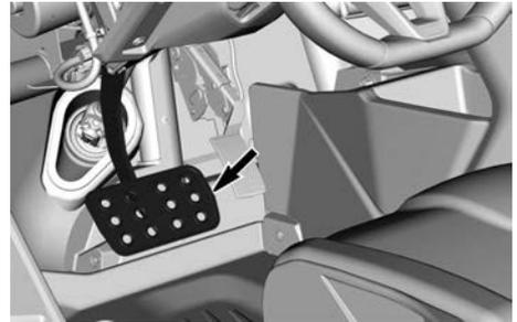
La funzione del pedale del freno consiste nel rallentamento o nell'arresto del veicolo.
