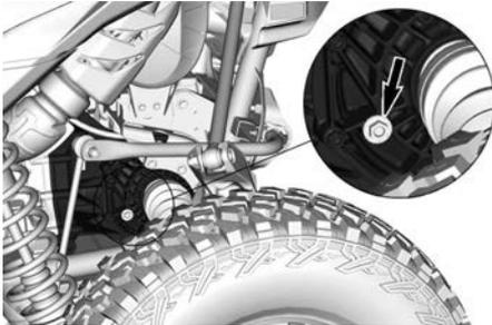
4. Rimuovere il tappo livello olio della trasmissione finale posteriore e l'O-ring.
