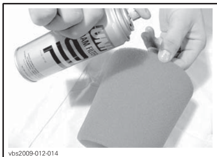
TÍPICA - LUBRIFIQUE O FILTRO DE ESPUMA
