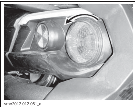
GIRE A LÂMPADA DA LANTERNA TRASEIRA NO SENTIDO ANTI-HORÁRIO PARA SOLTÁ-LA
