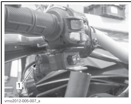
TÍPICO 1. Conexão do controle remoto
