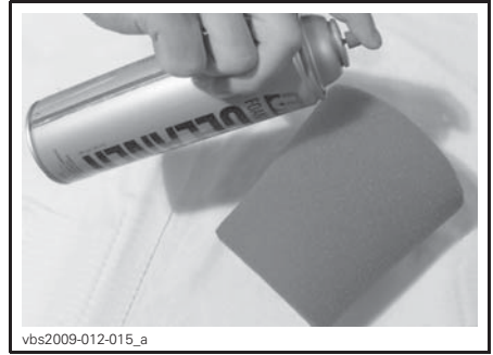
TÍPICA - BORRIFE O FILTRO DE ESPUMA
