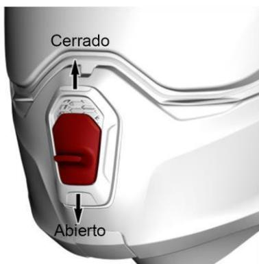
2. Los extractores situados en la parte superior tienen 2 posiciones de ajuste. Están totalmente abiertos o totalmente cerrados. En el modelo de invierno cuando el botón deslizante está en posición anterior, el modo corresponde a completamente abierto y cuando está en posición posterior, el modo corresponde a completamente cerrado. En el modelo de verano sucede todo lo contrario.
