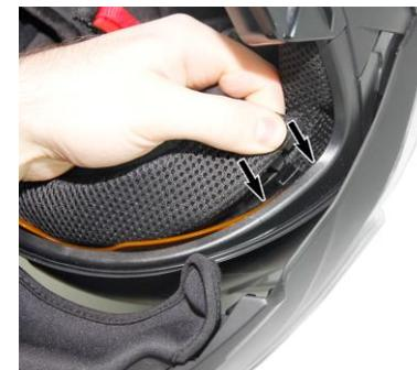
2. A continuación, coloca dentro del casco el revestimiento para la cabeza.
