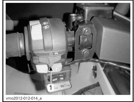
1. Interrupteur d'arrêt d'urgence du moteur
