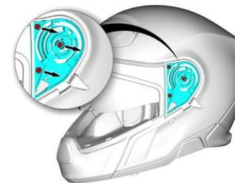
2. #1のプラスドライバーを使用して3つのねじを取り外します。
