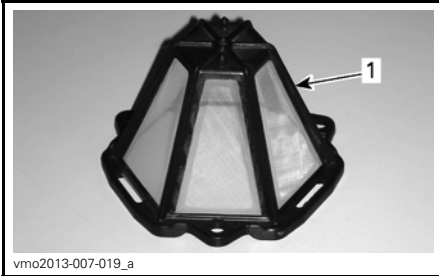
1. Filtre à air de la transmission CVC
