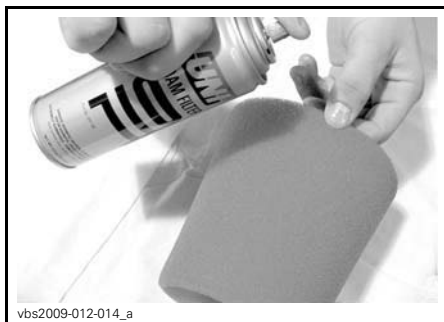
TYPIQUE - HUILER L'ÉLÉMENT EN MOUSSE
