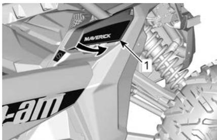
1. Cubierta del tapón del depósito de combustible
