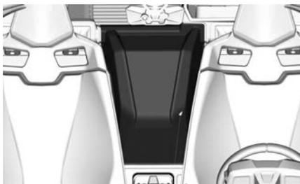
Retire los tornillos de fijación delanteros de la placa protectora.
