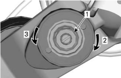
**AMORTIGUACIÓN DE COMPRESIÓN A VELOCIDAD ALTA (UTILICE UNA LLAVE DE 17 MM)**
