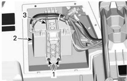
1. Tornillos de sujeción del portabaterías
